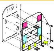
2- Choix du réglage en hauteur de la coque (réglage d'usine position 2, ajustable à la livraison sur les 4 positions
