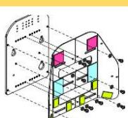
2- Choix du réglage en hauteur de la coque (réglage d'usine position 2, ajustable à la livraison sur les 4 positions
